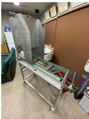
コンベア式ブロッコリー フローレットカッター試作機
