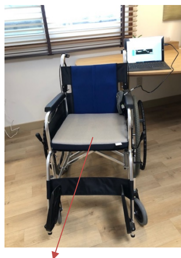
センサ組み込みクッション 【試作した車椅子用センサ】
